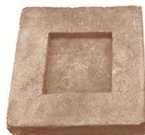
那珂湊反射炉で使用された耐火煉瓦 (釜石市立鉄の歴史館蔵)
